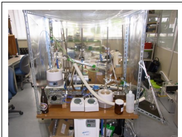
図1 バイオエタノール精製プラント
